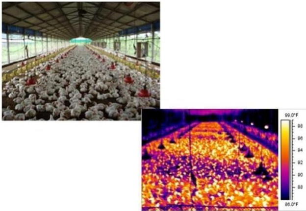
Figura 3 – Imagem de um galpão através de câmera termográfica.
